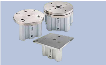
台灣 金器 三軸導桿氣缸 ■ 內徑 :Φ 63~125mm ■ 行程 :30~150mm ■ 可搭配 90 或 180 度旋轉平台 ■ 使用滾柱或滾珠軸承
