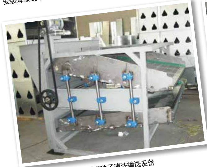
安装焊接式不锈钢摇臂的食品振动输送设备
