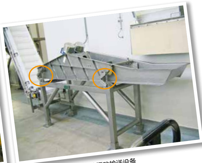
不锈钢ABI型支撑用于蔬菜振动输送设备
