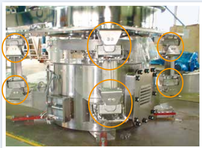
回转筛选设备上安装8只不锈钢材质的万向接头AK-I 40
