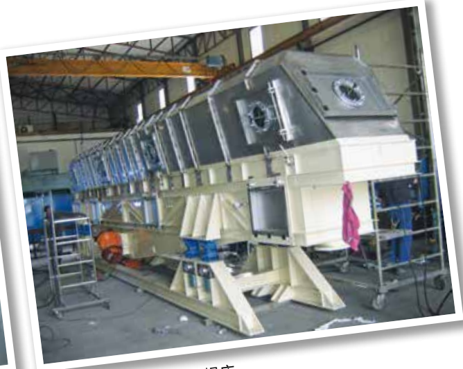
AB-D 型支撑用于硫化干燥床
