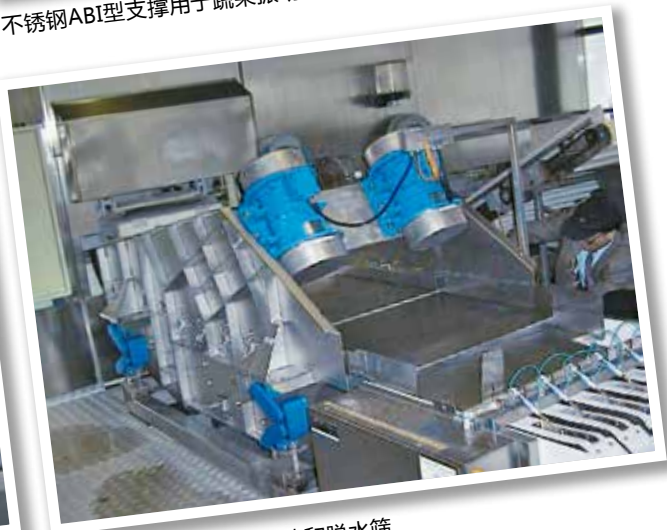
AB型支撑用于蔬菜的清洗和脱水筛
