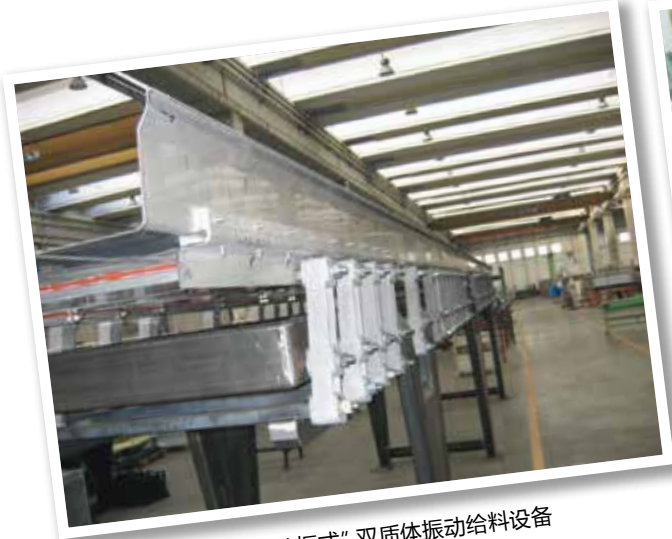
安装双摇臂AD-P 50的双质体振动給料设备用于输送松散物料
