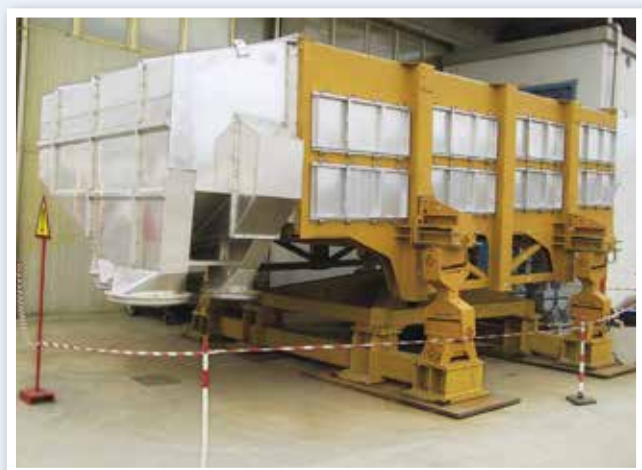
木片回转筛分设备上安装8只万向接头AK 100-4支撑
