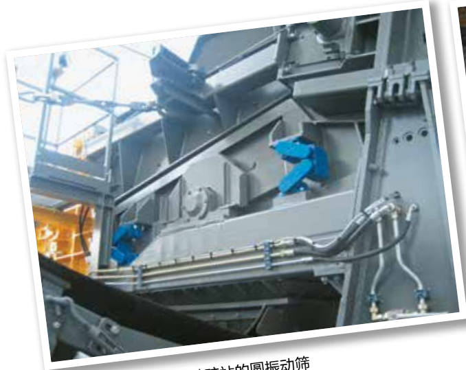
AB-D 型支撑用于硫化干燥床
